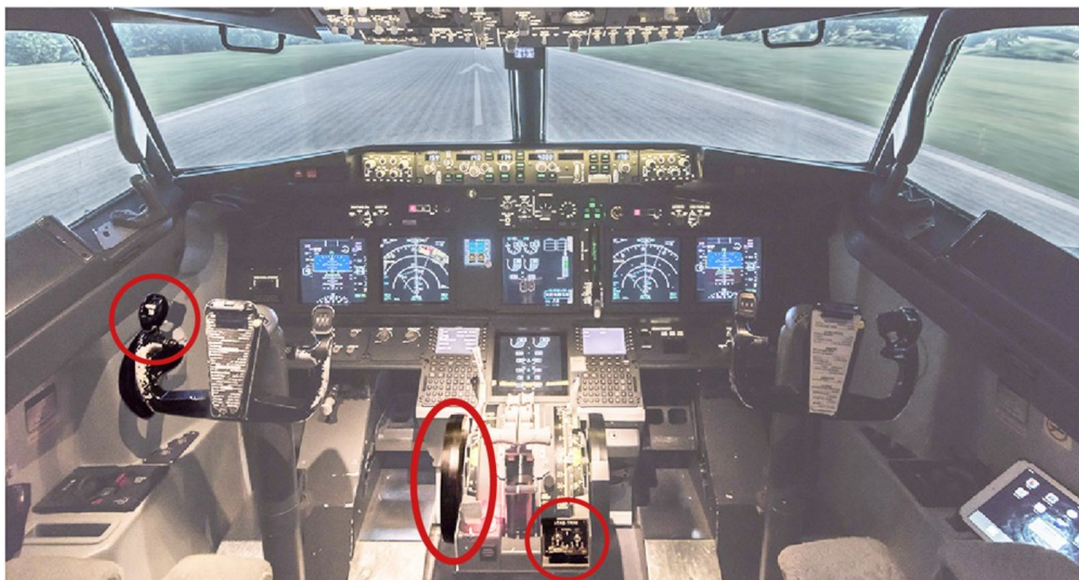
Un cockpit de Boeing 737 Max et les trois zones d'action qui auraient pu permettre aux pilotes de compenser manuellement les défauts du MCAS en vol. - SIPA
